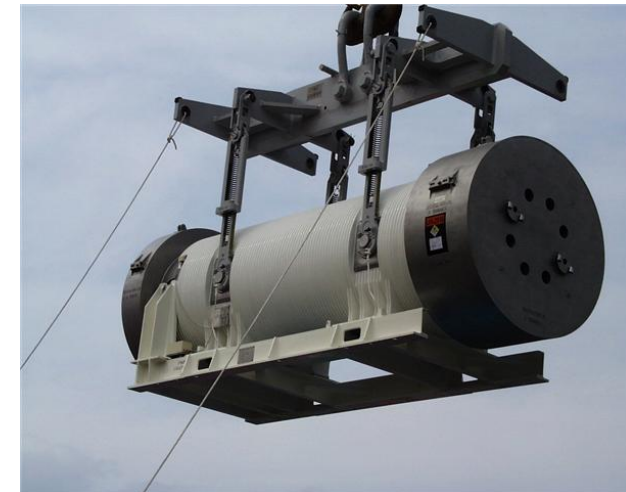
東芝製 中間貯蔵用金属キャスク例 [ BWR69体タイプ ]
