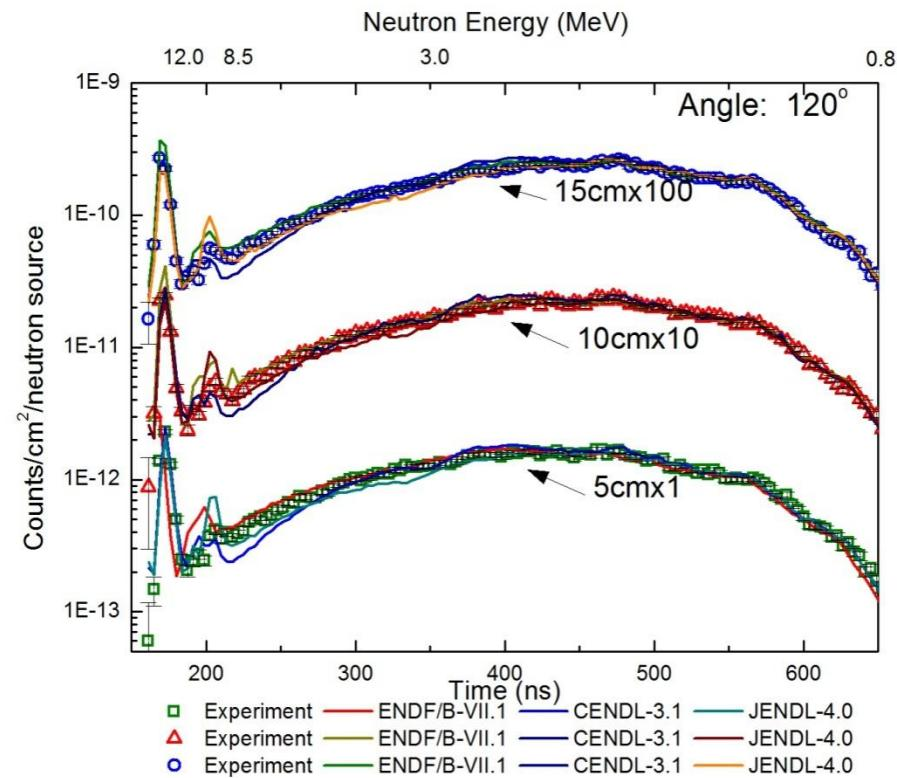
不同厚度铁样品  $60^\circ$ ,  $120^\circ$  泄漏中子飞行时间谱实验结果和模拟结果比较
