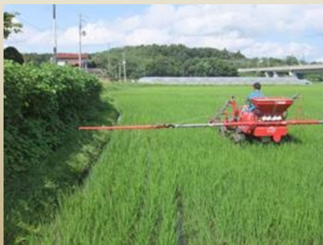
ビークル(乗用肥料散布機)による加里肥料の散布
