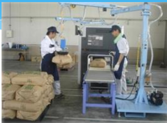
②袋をベルトコンベアに載せ、検査器で測定
