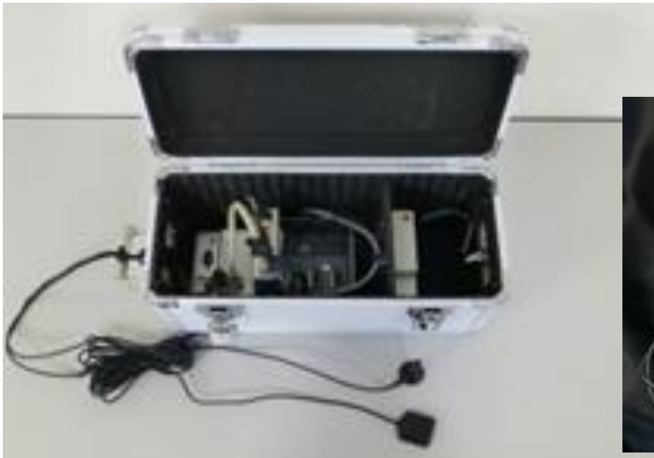
Environmental radiation detectors (KURAMA-2 system)
