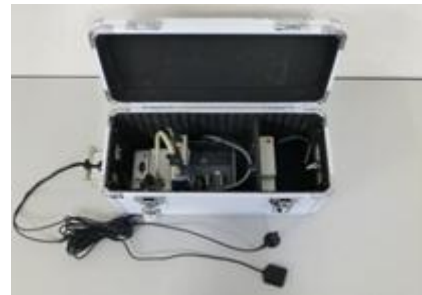
Environmental radiation detectors (KURAMA-2 system)
