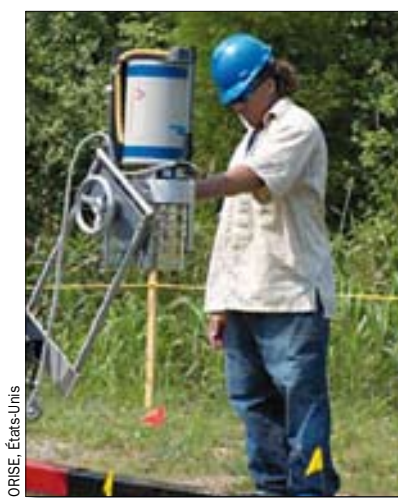
Contrôle de radioactivité à l'aide d'une spectroscopie gamma in situ .
