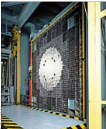
Assemblage de combustible pour réacteurs à neutrons rapides de la JAEA pour expériences sur des maquettes critiques.
