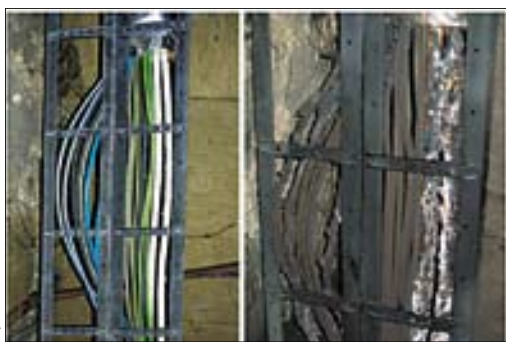
Essai d'incendie de câbles : avant et après essai.
