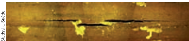
Rupture de gaine d'un combustible fortement irradié soumis à une rampe de puissance (Studsvik).
