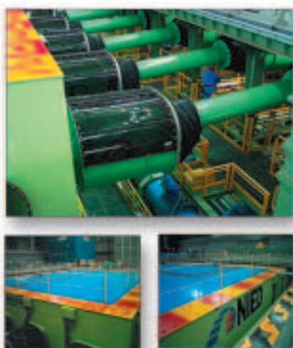
Vues de la plus grande table vibrante du monde, récemment construite à Miki au Japon.
