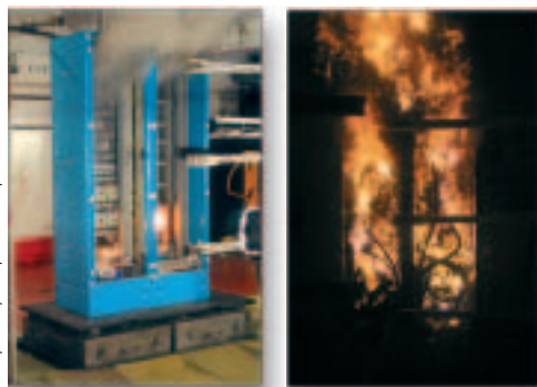
Étude des conséquences d'un incendie d'armoire électrique (Programme PICSEL, Cadarache, France).
