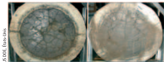
Projet MCCI : coupe de deux sections d'essai de pénétration d'eau, après essais. Les essais ont été réalisés pour deux compositions du corium contenant respectivement 8% (photo de gauche) et 25% (photo de droite) de béton. On peut voir que le spécimen contenant 8% de béton est plus fissuré que le spécimen à 25% de béton, ce qui laisse penser que le noyage serait plus efficace si le cœur fondu contenait moins de béton.
