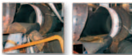
La rupture de tuyauterie survenue sur la tranche 3 de la centrale de Mihama en août 2004 est à l'origine de la décision par le Japon d'examiner les rapports de maintenance de ses 22 tranches REP.
