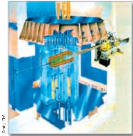
Le réacteur MASURCA du CEA Cadarache, en France, couplé à l'accélérateur GENEPI, est utilisé dans les expériences MUSE.
