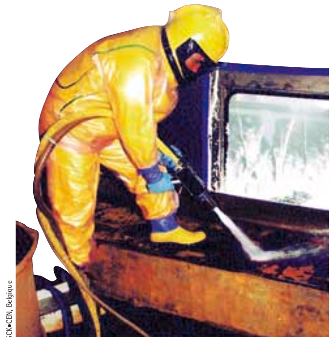
Décontamination de grands composants par jet abrasif.
