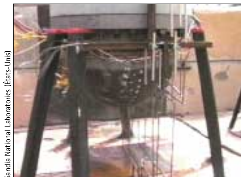
Projet d'étude de la rupture du fond inférieur de la cuve (Laboratoires Sandia). Vue du fond inférieur équipé de capteurs.
