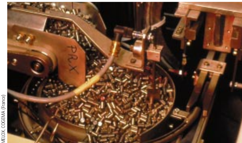
Fabrication des pastilles de combustible MOX dans l'usine MELOX, en France.
